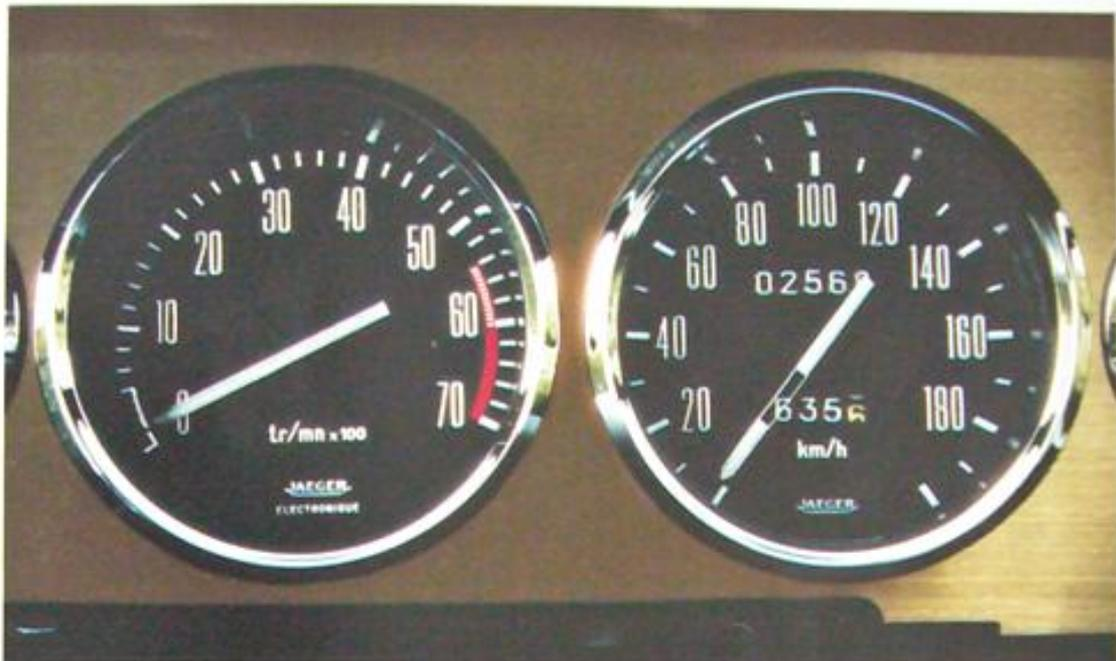
Elektronischer Drehzahlmesser und Tachometer mit Tageskilometerzähler.
