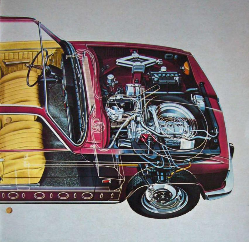
Kraftübertragung über Antriebswellen mit homokinetischen Gelenken.
