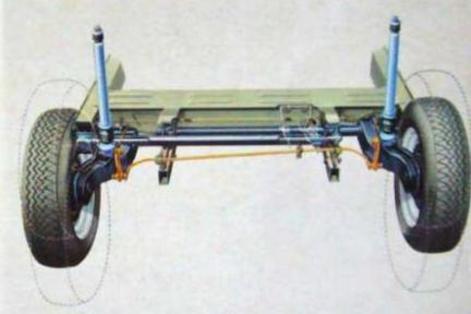
Stoßdämpfer an allen 4 Rädern. Querstabilisator vorn und hinten.
