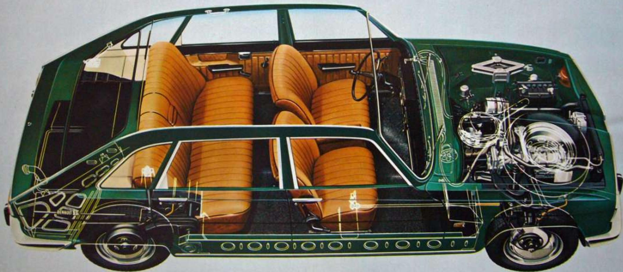
Aluminium-Motor: gute Wärmeleitfähigkeit, korrosionsbeständig, leicht. Nasse, auswechselbare Zylinderlaufbuchsen. Hermetisch verschlossenes Flüssigkeitskühlsystem. Keine Kühlwassersorgen, keine Frostschutzsorgen, leiser Motorlauf. Scheibenbremsen vorn. Trommelbremsen hinten. Bremskraftregler an den Hinterrädern.
