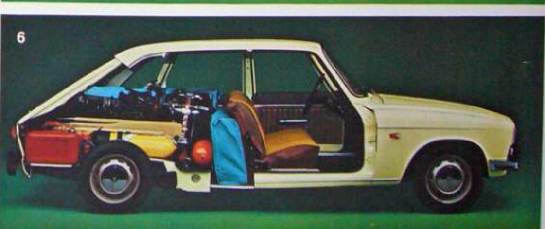
Der Renault 16 ist nach dem Prinzip der Flugzeugzelle gebaut. Geschlossene Holme und doppelte Seitenwände, fest mit dem Chassis verbunden: Gewähr für absolute Sicherheit.
