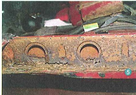
Der Zustand des gelochten Längsträgers nach Auftrennen der Schwelle.
