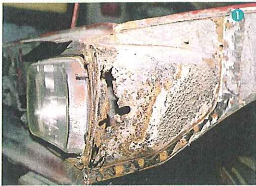
Überraschung nach der Kotflügel-Demontage: Stehblech und Lampentopf weisen Rostlöcher auf.
